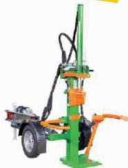
**Fendeuse POSCH HYDRO-COMBI 13 tonnes sur châssis routier**
