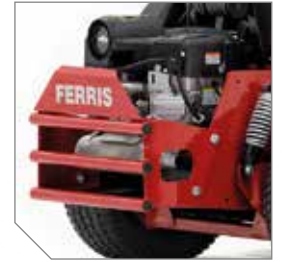
Robustes renforts arrière protégeant le moteur et permettant également un accès facile pour la maintenance.
