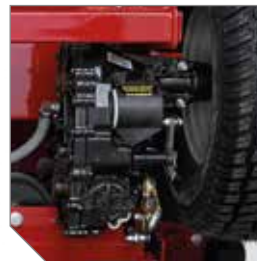
Transmission professionnelle Hydro-Gear® ZT-3400 hautes performances permettant une durée de vie hors normes.
