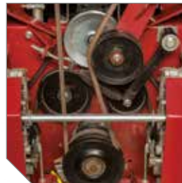
Enroulement de plus de 180° de la courroie sur la poulie d'entraînement principale pour garantir la transmission de puissance. Entrainement du rotor assuré par une courroie double, collée.
