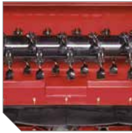
34 couteaux (17 paires) en "Y", coupelles de protection des roulements de rotor, bavette caoutchouc flexible anti-projections.
