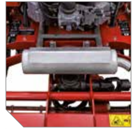
Entrainement par un arbre à cardan résistant et un renvoi d'angle entre le moteur et le broyeur.
