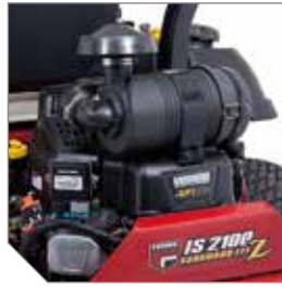
Moteur Vanguard™ 810cc EFI délivrant une puissance optimum avec une consommation de carburant réduite.
